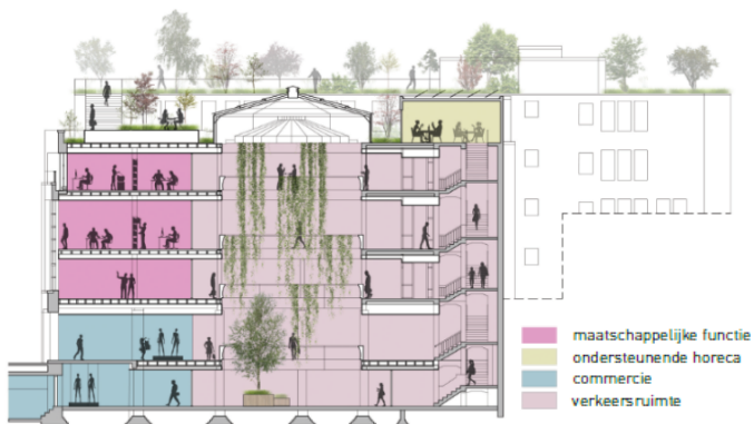
Figuur 10: doorsnede met centraal trappenhuis
